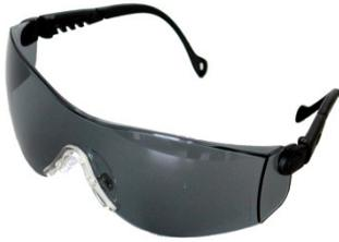
**Lunettes mono écran en polycarbonate teinté gris traité anti-rayures, pour travaux mécaniques : meulage, tournage, fraisage...**
