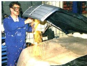
**Bâche de protection très souple, tissée avec des fibres de silicate, assurant une parfaite protection des zones couvertes.**
