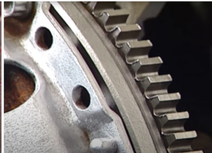
Nettoyer les surfaces irrégulières
